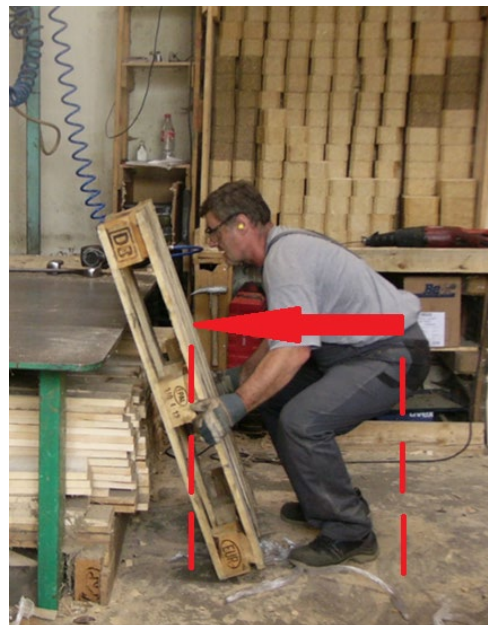
Model 1, rækkeafstand. Eksempel på rækkeafstand svarende til \frac{3}{4} arms afstand Det er den største rækkeafstand under løftet, der skal bruges ved vurdering af et løft 14 .
